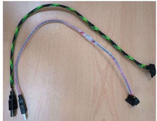
Figure 16 et 17 - Ancien serveur et Câble d'alimentation SATA vers USB
