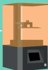
2 imprimantes 3D résine / UV qui utilisent un laser frappant le liquide qui se solidifie sous l'effet des UV.
