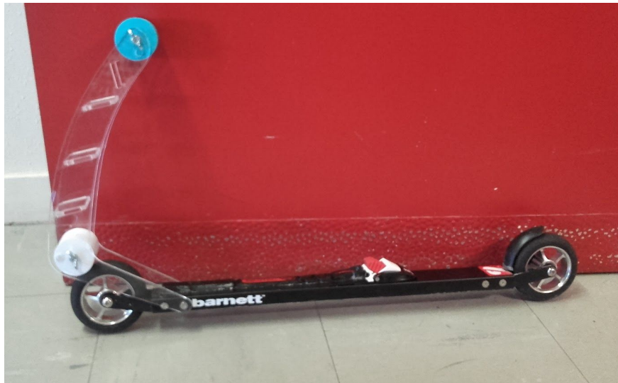
Prototype final en plexiglass assemblé sur le ski
