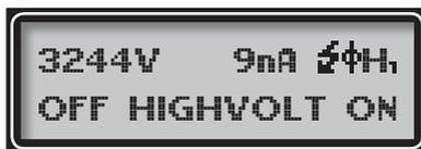
L'écran de haute tension vous informe sur la tension et le courant au fil corona pour la charge des particules. Vous pouvez désactiver ou activer la haute tension en appuyant sur la touche flèche gauche ou droite en dessous de l'affichage Off/On. Si la haute tension est désactivée, le testo DiSCmini fonctionne comme électromètre d'aérosol si les courants des deux étages sont additionnés.
