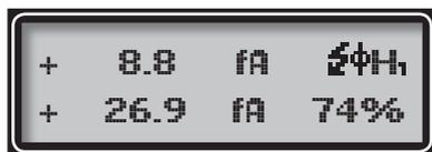
L'écran des données brutes montre les courants mesurés dans les étages de l'électromètre en fA ; la valeur supérieure correspond à l'étage de diffusion, la valeur inférieure à l'étage de filtrage. Ces valeurs ne présentent pas de correction offset, donc pas les valeurs réelles mesurées, il s'agit plutôt d'une valeur de mesure après déduction du décalage (offset).
