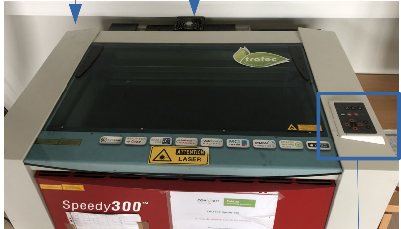
Ventilateur de refroidissement du tube laser
