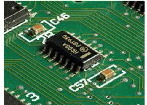
Figure 1 Composants montés en surface
