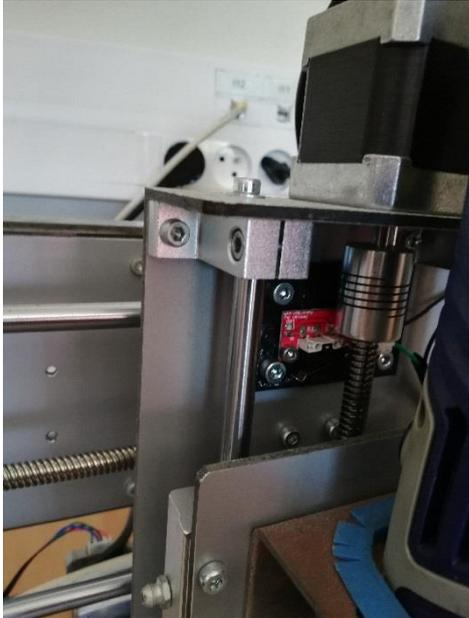
Figure 20 Interrupteur Z
