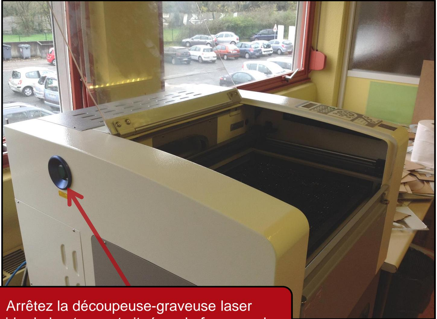
Arrêtez la découpeuse-graveuse laser à l'aide du bouton vert situé sur la face gauche
