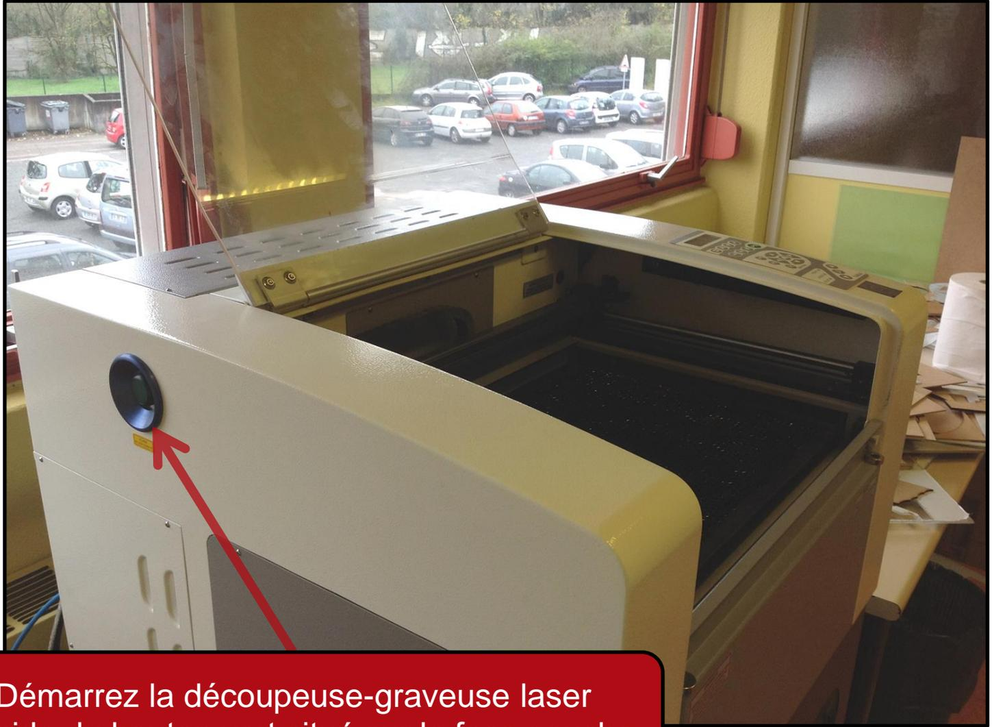
Démarrez la découpeuse-graveuse laser à l'aide du bouton vert situé sur la face gauche
