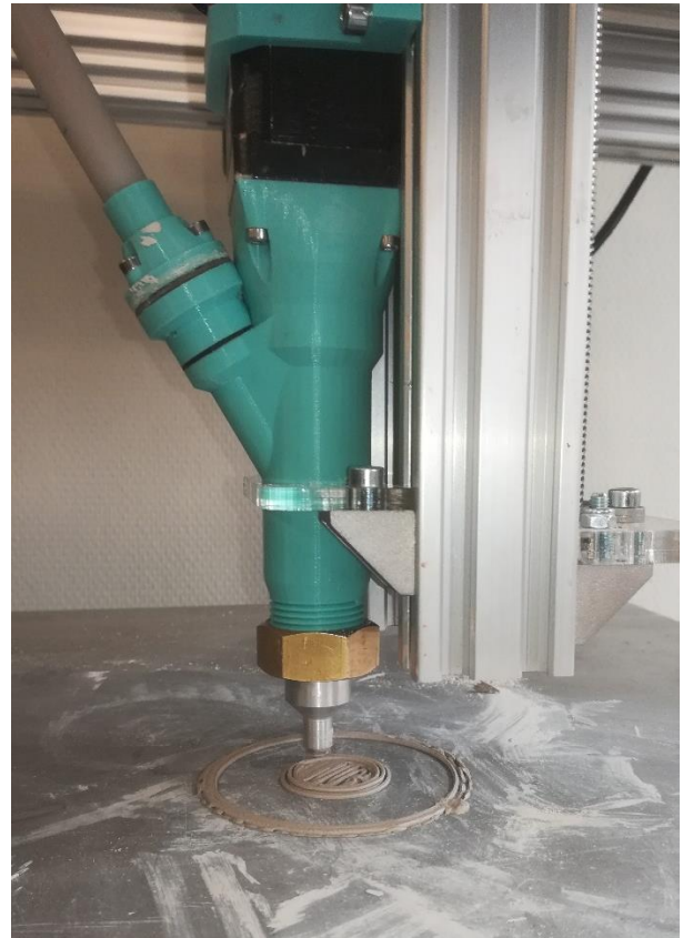
Figure 31 : Impression avec l'extrudeuse "Dart"
