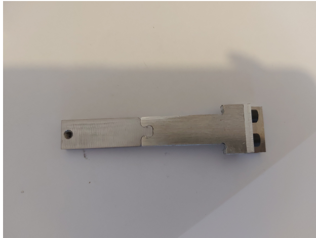
Figure 12: Pièces du kicker usinées (pièce gauche en acier)
