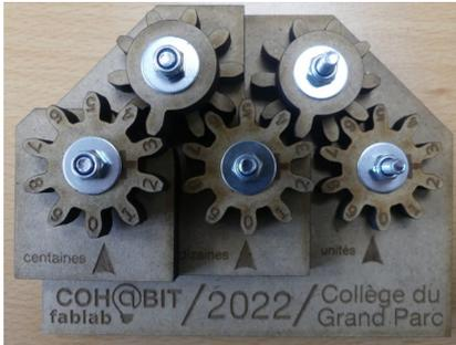
La pascaline est une petite machine à engrenages, constituée de roues dentées, qui permet d'écrire des nombres et de faire des calculs. Elle s'appelle pascaline en référence à la fameuse machine à calculer mécanique construite par Blaise Pascal.
