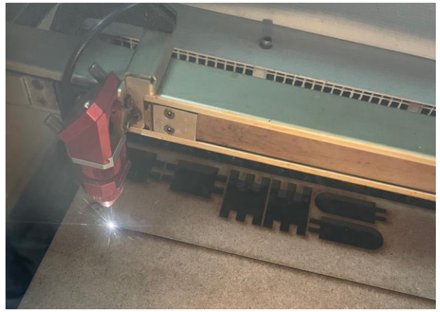
Figure 16 : Découpe laser en fonctionnement
