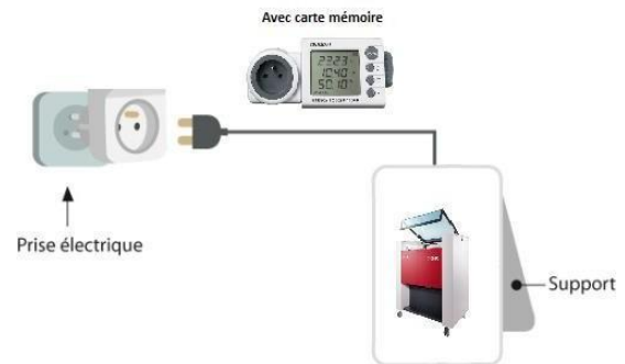
Figure 3 : Schéma du montage du VoltCraft
